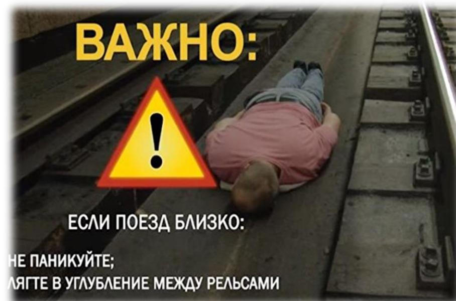
**Не прячьтесь под платформу, т.к там контактный рельс под высоким напряжением, идущий вдоль края платформы!**
